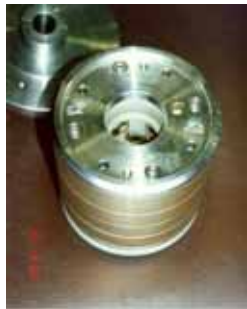
写真3 : (上) 探触子回転式超音波探傷装置 (下) 探触子ブロック
