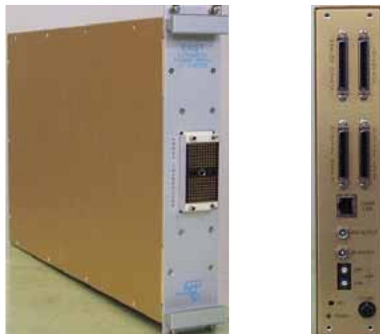
写真 2：オンライン検査用フェイズドアレイ 超音波探傷器
