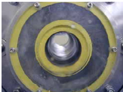
写真4 : (上) 超音波音場回転式探傷装置 (下) 水膜形成の様子
